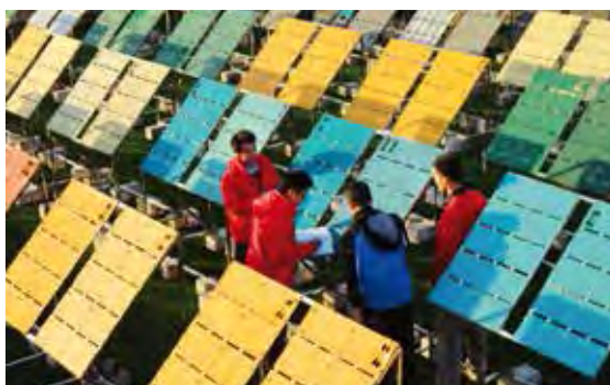
● 世界最大聚脲样片曝晒试验场
